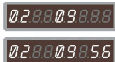
Таким образом, последовательно, вводим все шаги программы. Если какую-либо секцию нужно выполнить несколько раз подряд то столько же раз вводим ее номер.
